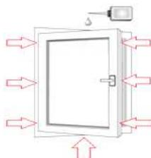
Limpe as juntas de vedação com água e para as lubrificar, utilize um líquido de lubrificação adequado.
